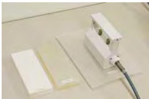
従来必要であったPCなしでのシート状試料測定が可能に、またA4プリンタ接続で詳細結果を印字可能です。
