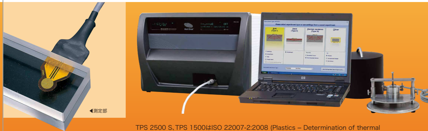
TPS 2500 S、TPS 1500はISO 22007-2:2008 (Plastics – Determination of thermal conductivity and thermal diffusivity – Part 2: Transient plane heat source (hot disc) method)に準拠した装置です。
