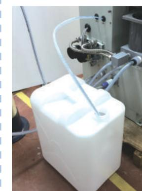
酸性廃液の分別回収処理が必要な場合、測定廃液のうち、酸廃液・モリブデンを含む廃液と、通常廃液を分けて排液できます。
