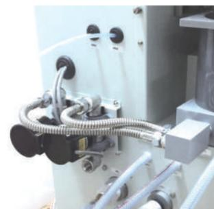
設置場所などの関係で2種類の試料水を1台の装置で測定したい場合、異なる経路のサンプルを交互に測定できるように、2点経路切換ユニットを追加できます。それぞれの経路で個別の濃度範囲で測定が行えます。
