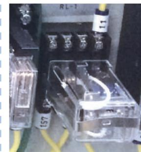
装置の状態確認信号として、装置電源が停電した際に電源断信号を出力できます。
