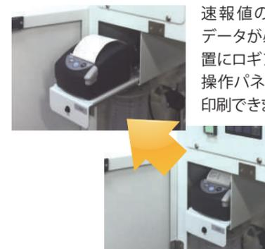
速報値の連絡用、すぐに印字データが必要な場合などに、装置にロギングした測定データを操作パネルより期間を指定して印刷できます。
